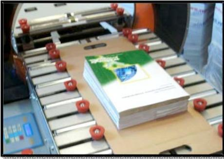
Das Format des Zuschnitts wird automatisch erkannt und einem der zehn einstellbaren Wickelprogramme zugeordnet.
