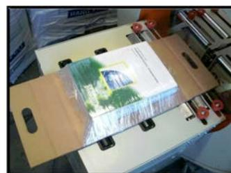
Das automatische Schneidsystem trennt die Folie am Ende des Zyklus ab und greift die Folie für den nächsten Zyklus. Der Zuschnitt ist jetzt bereit in den Karton eingesetzt zu werden.
