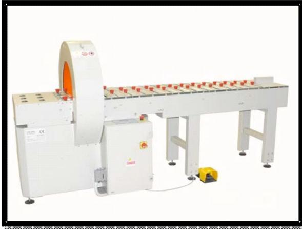
Die BC-40 CA ist ein vollautomatischer, horizontaler Stretchwickler zum Bündeln und Spiralwickeln von Produkten, die auf einem Wellpappzuschnitt fixiert werden sollen.
