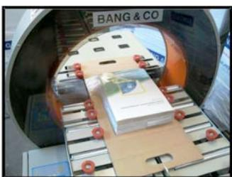
Der Ring wickelt das Produkt mit Stretchfolie auf dem Zuschnitt fest. Die Start und Stopp-Position, sowie die Anzahl der Wicklungen, die Dreh- und Vorschubgeschwindigkeiten sind in dem entsprechenden Programm gespeichert.
