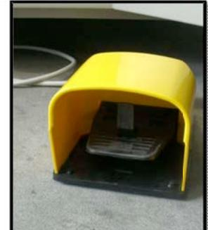
Der Wickelprozess wird durch Betätigen eines Fußschalters ausgelöst.
