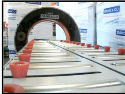
Die Zentrierung des Zuschnitts auf dem Einlauförderer erfolgt vollautomatisch.
