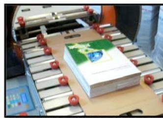
Die Maschine startet den Zyklus indem sie den Zuschnitt auf dem Einlauförderer automatisch zentriert und dem Wickelring zuführt. Der Zuschnitt wird je nach Größe automatisch einem Programm zugeordnet.
