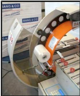
Der sichere und schnelle Zugang zu den Folienrollen gewährleistet einen schnellen Rollenwechsel
