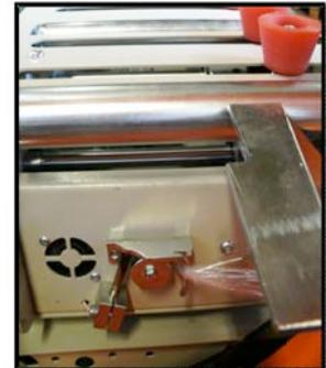
Automatisches Folienschweißsystem zum Klammern und Abschneiden bei Zyklusende.
