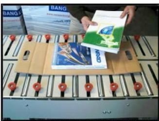
Der Zuschnitt wird auf den Einlauförderer gelegt. Das zu verpackende Produkt wird auf dem Zuschnitt zwischen den beiden Rillungen des Kartons positioniert. Nach dem Beladen startet der Bediener die Maschine
