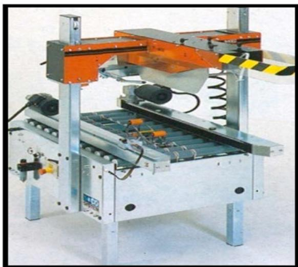
Bei der T-402 wird obere Klebeeinheit von zwei Säulen getragen. Dadurch erhält die Maschine mehr Stabilität und es empfiehlt sich insbesondere bei großen Kartonformaten.
