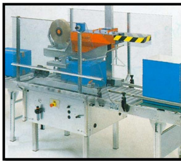
Zur Vermeidung von Betriebsunfällen besteht die Möglichkeit eine Plexiglasabschirmung nachzurüsten. Beim Öffnen dieser Abschirmung wird die Maschine automatisch ausgeschaltet.
