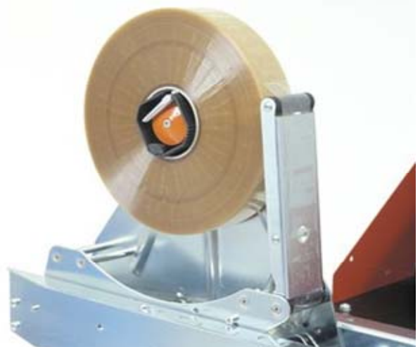
Die Rändelmutter des Dispensers gewährleistet einen einfachen und schnellen Klebebandwechsel. Gleichzeitig wird die Klebebandrolle während des Verschlussverfahrens festgehalten.
