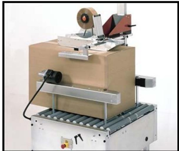
Angehobene Seitenantriebe für hohe Kartons. Zusätzlich sorgen je vier breite, parallellaufende Rollen für den Zusammenhang des Kartons bei leichter Überfüllung. Dadurch ist das richtige Aufbringen des Klebebands auf der Mittellinie stets gesichert.
