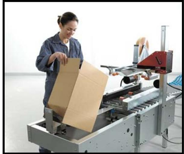
Die vordere und hintere Klappe werden in Richtung Schiene gefaltet.
