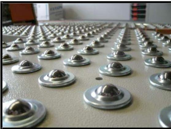
Kugelrollen in der Tischoberfläche erleichtern das Handling der Reifen während des Wickelprozesses.
