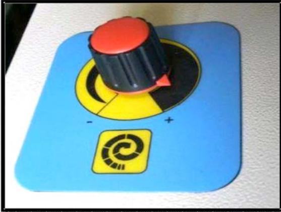
Einfache Regulierung der Drehgeschwindigkeit über einen Frequenzumrichter.
