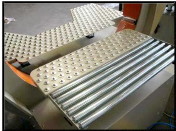
Nach Zyklusende werden die verpackten Reifen mittels einer Rollenbahn weiter befördert.
