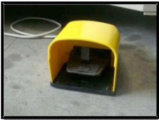
Der Wickelprozess wird durch Betätigen eines Fußschalters ausgelöst und beendet.
