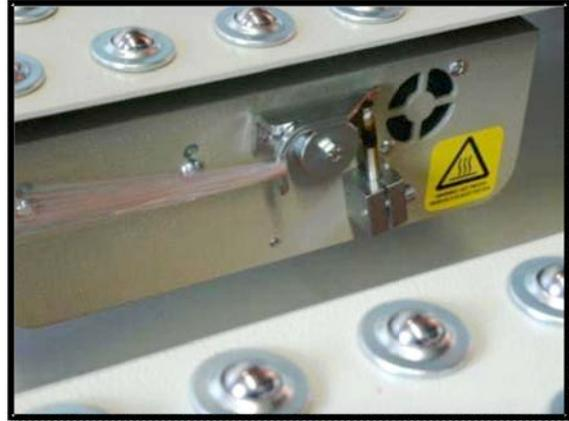
Automatisches Folienschweißsystem zum Klammern und Abschneiden der Folie bei Zyklusende.
